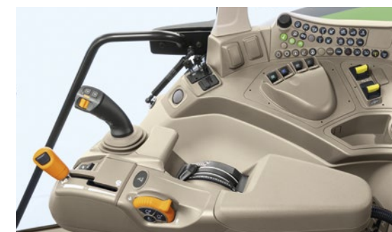
Управление на AutoPowr™ чрез конзолата CommandARM™
