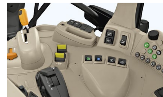
Управление на AutoPowr™ чрез дясната конзола с електронни SCV изводи
