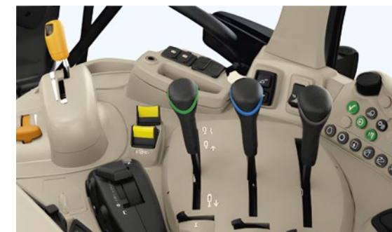
Управление на AutoPowr™ чрез дясната конзола с механични SCV изводи
